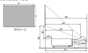
H:スクリーンの横幅 ※この図は正確な縮尺ではありません V:スクリーンの機幅 ※この図は正確な縮尺ではありません V:スクリーンからレンズのミラー反射面 A2:スクリーンからプロジェクター後面 A3:スクリーンからプロジェクター前面 A4:スクリーンからレンズの投写窓中心 A5:スクリーンからレンズ先端 B1:スクリーン下端からプロジェクター天面 B2:スクリーン下端からプロジェクター底面(地面) \*寸法 A1 のミラー反射面は、レンズの内部にあるため確認できません。
