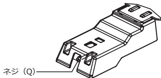
7. 固定金具 (A) を固定金具 (B) に取り付けます。
