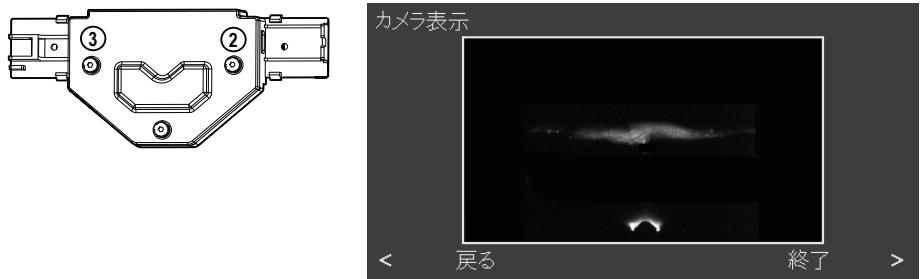
(11) スクリーン右下および左下の調整バーがそれぞれ1点のみ発光するまで、調整ノブ①を反時計回りに回してください。
