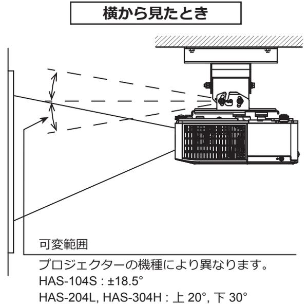
**3.** 映像がスクリーンに対して傾きなく投影される様に合わせ、傾き調整ネジをしっかりと締めてください。
