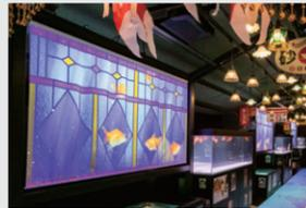
スクリーン前の天井から超短投写プロジェクターで約90度を投写。スクリーン近くを歩いても影がでさく間近で鑑賞できます。
