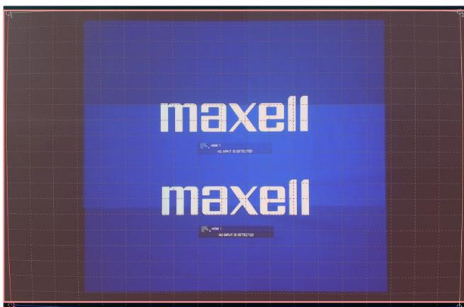
選択した領域に対して理論補正された画像は、赤で表示された大きさとなります。それに対して、実際のプロジェクター投写領域は、青の編み掛け部分になります。
