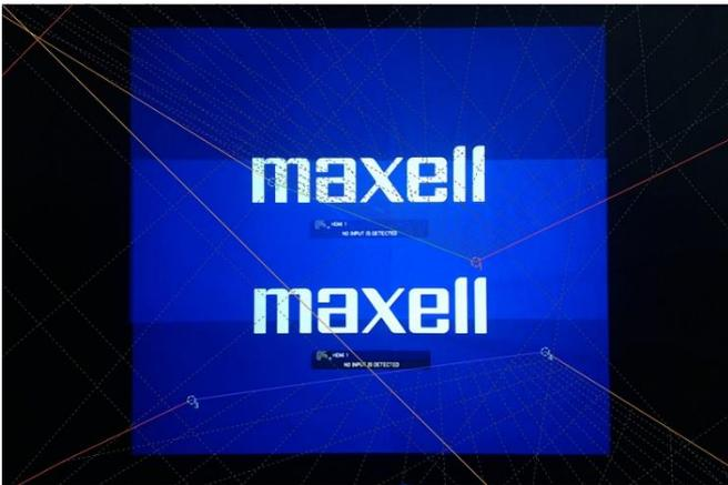
Image Boundary では、選択範囲が投写画像よりも極端に小さい、コーナー補正点が入れ違いになる(1 が 2 よりも右にある)など、その補正形状が、長方形からかけ離れ、大きな歪のある幾何学補正がかかる場合は画面破綻が発生する可能性があります。
