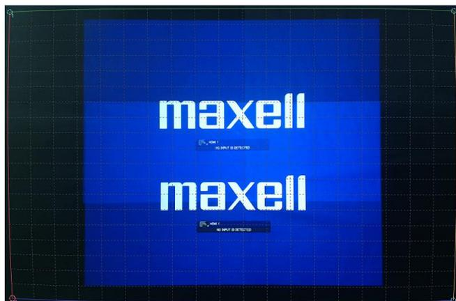
中央にある垂直方向に 2 面投写されている領域よりも広い範囲を選択します。領域を選択する時は、左図 1～4 のコーナー補正点を左クリックすることで補正対象点として選択し、そのまま左クリックし続け、プレビュー画面内の好きな場所にドラッグした後に、左クリックを離すことで決定となります。
