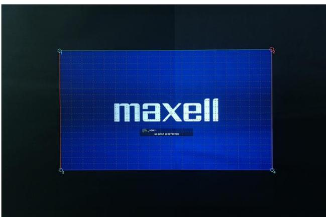
上記より Update Calibration を実施し Blending を行うと、最終的には、青の編み掛け部分に投写するため、上下に黒を付け加えた左図のような画像が投写されます。この場合、上下プロジェクターそれぞれに最適化された WarpMap が送られます。
